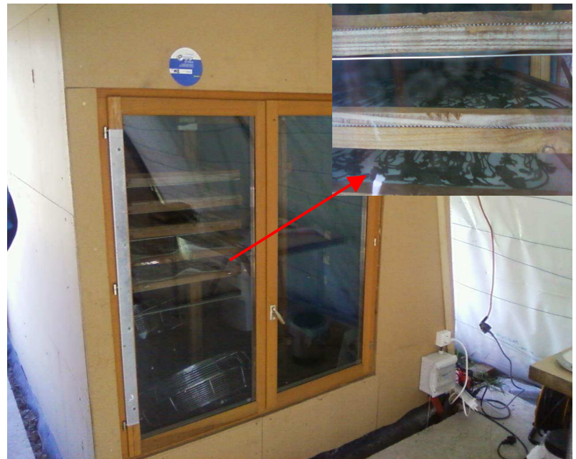
Le four de fabrication artisanale. Les algues sont séchées à une température de 40 °C pendant 4 à 7 heures.
