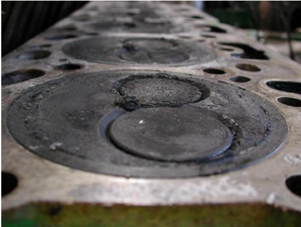
(Figure : (A.20), AAN ; vue sur culasse et soupapes avec formation d'une « trompette »)
