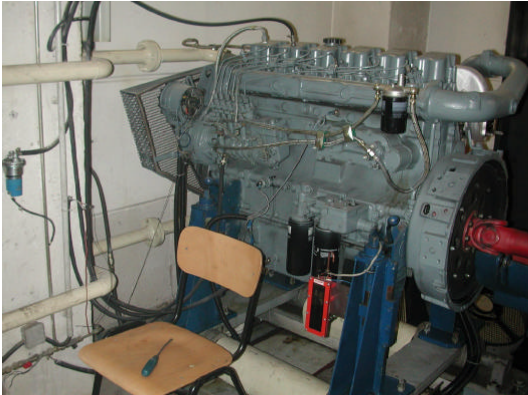
(Figure : (A.14), laboratoire AAN ; Nommé 6 P 13,5 ; Moteur sur banc d'essai AAN, 6 cylindres, 8.85 dm 3 , 130 kW)
