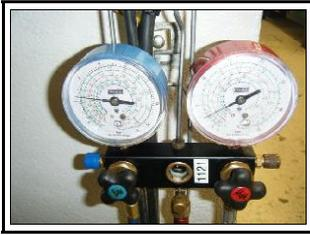
Manifold de service 3 voies, avec flexibles
