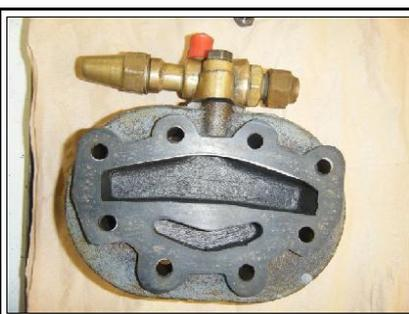
Compresseur à piston, plaque à clapet
