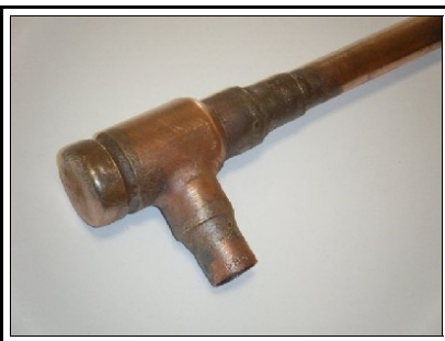
Piège à huile – les éléments assemblés
