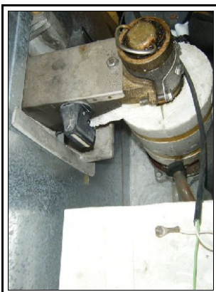
Machine à glace écaïlle, détail de la visse sans-fin.
