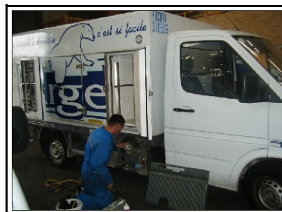
Camion frigorifique à plaques eutectiques
