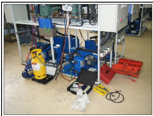
Chambre froid négatif en cours de mise en service (charge en fluide)
